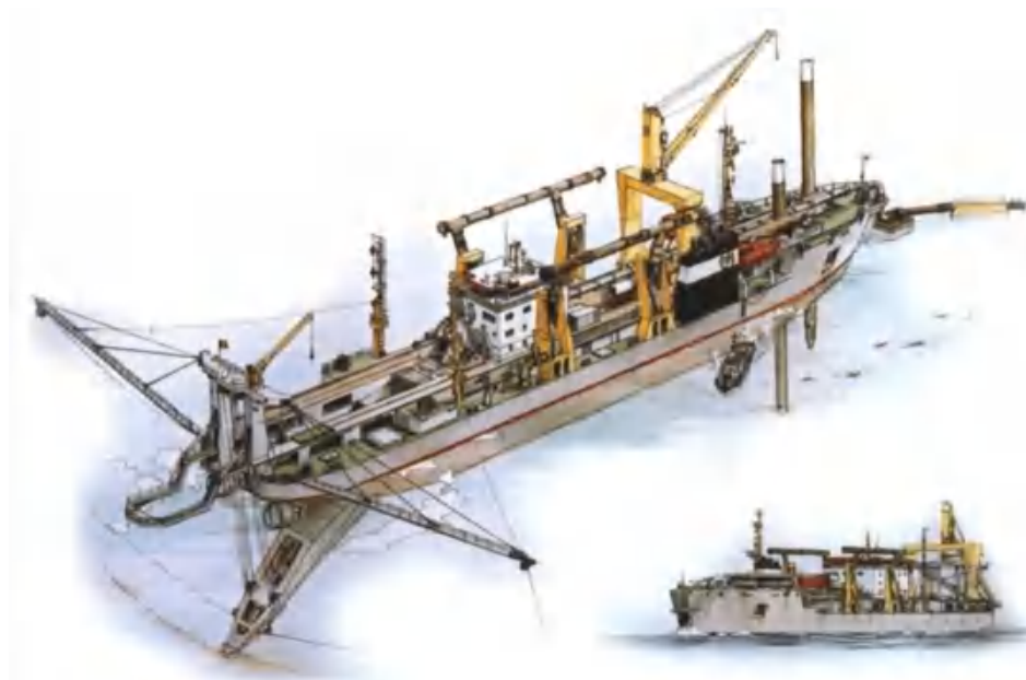
图 3.15-6 绞吸船施工示意图
