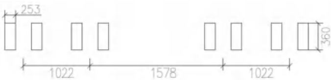
图 3.9-2 流动荷载走轮布置图
