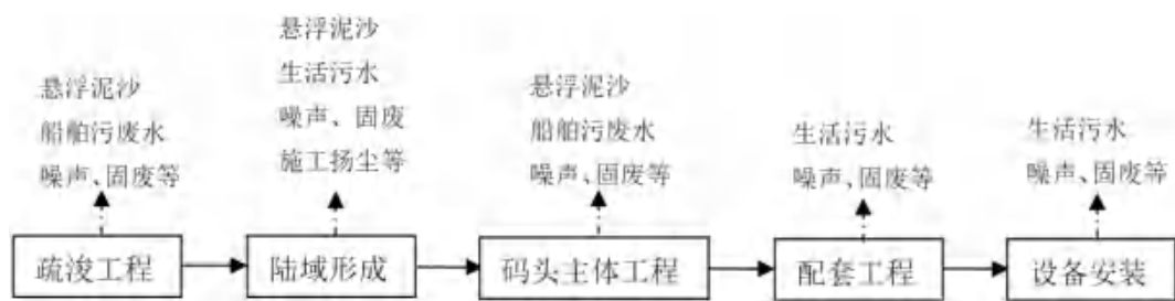
图 4.1-1 本项目施工过程及主要产污环节图
